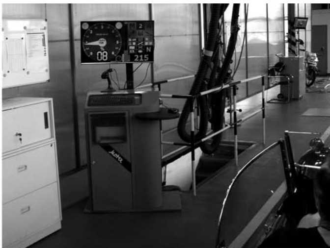
Zkouška zadních brzd: nesouměrnost brzdění 8% při síle na brzdový pedál 215 N (před seřízením to bylo 22%!)
