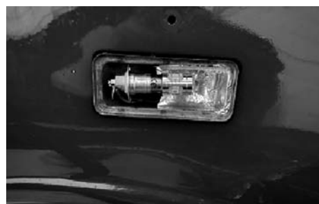
Obr. 14 Dvoubarevná LED v obrysovém světle EMW 327
