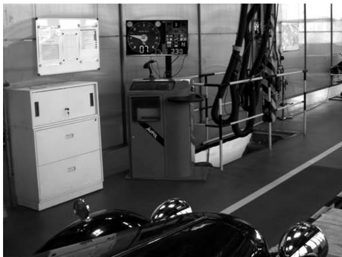
Zkouška předních brzd: nesouměrnost brzdění pouhých 7% při síle na brzdový pedál 230 N
