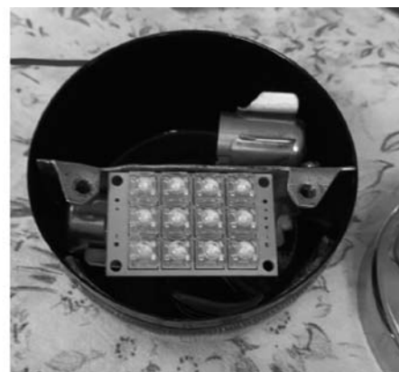
Obr. 9 Náhrada spodní objímky LED destičkou
